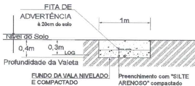
FIGURA 7 – DETALHAMENTO VALETA COM 1 NÍVEIS DE TUBULAÇÃO
