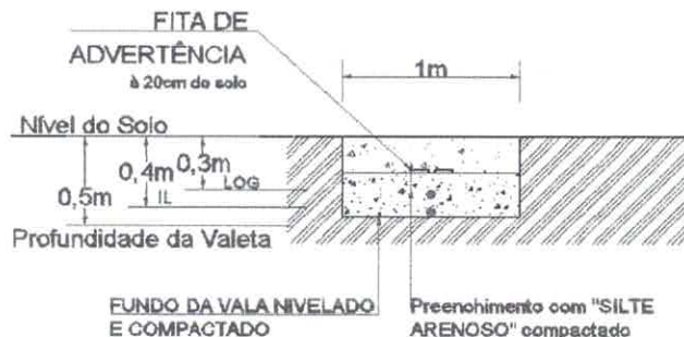
FIGURA 6 – DETALHAMENTO VALETA COM 2 NÍVEIS DE TUBULAÇÃO
